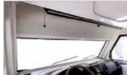
Rys.6.13 - Pozycje rolety zaciemniającej na przednią szybę
