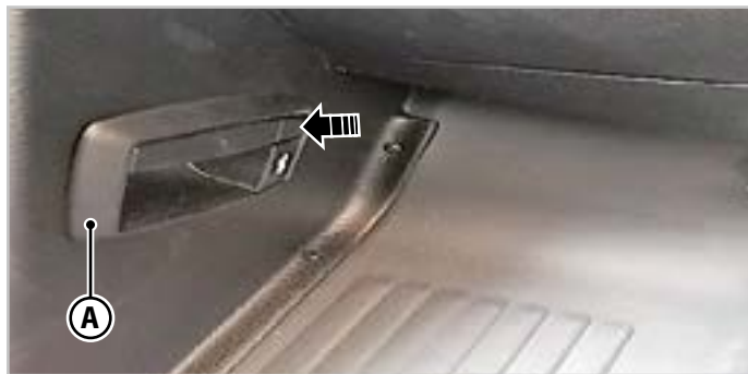
5.9 . ábra - A motorházatető kioldó karja - B típus
