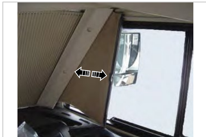
Fig. 6.11 - Stores occultant pliables pour baies latérales
