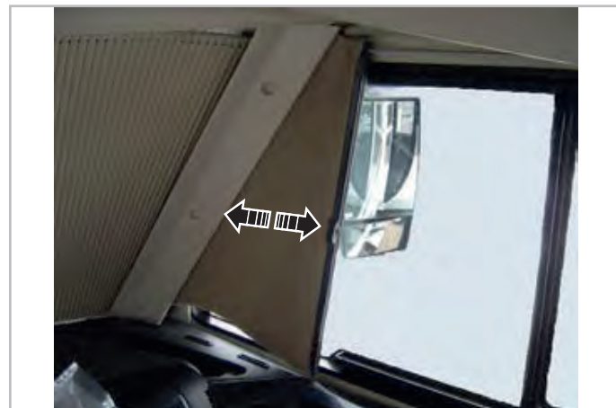
Fig.6.11 - Sammenfoldelige mørklægningsgardiner til sidevinduer
