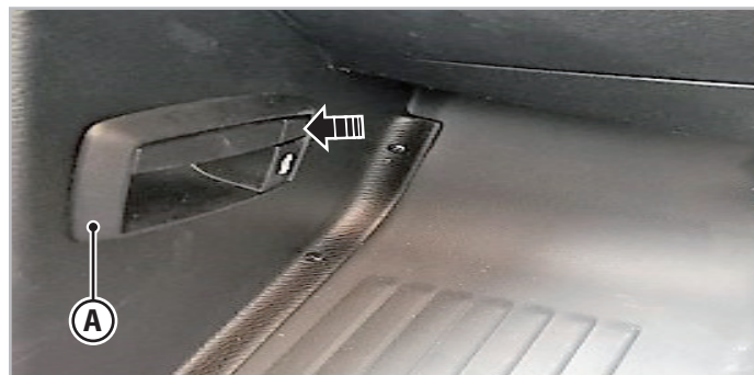
Fig.5.9 - Greb til åbning af motorhjelms - Type B
