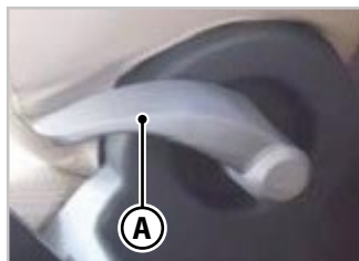
Fig.3.4 - Mando de regulación del respaldo
