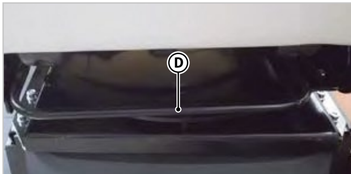
Fig.3.7 - Palanca de deslizamiento del asiento
